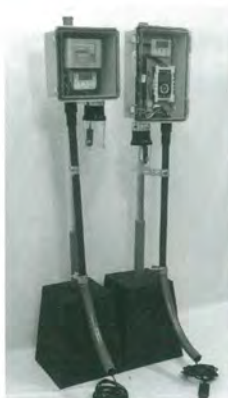
1多センサー連続計測器 [Dr.KAKASHI]。電源は乾電池で、低コストも実現
